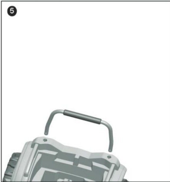
Установка заднего поручня Закрепите поручень в нужном месте на кузове.
