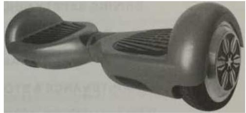
Гироскутер точно просчитывает действия водителя и контролирует ускорение. Smart управляется движением тела вперед, назад. Как только водитель становится на педали, гироскутер начинает движение.
