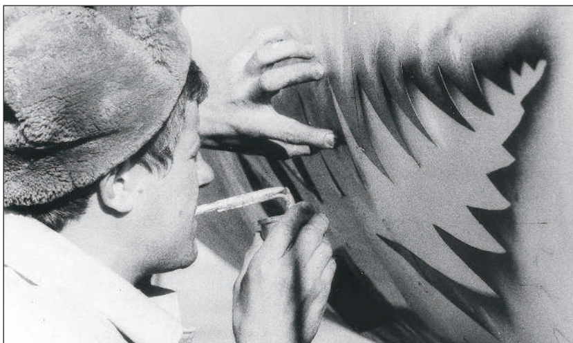
Технология нанесения эмблем в полевых условиях с использованием самодельного аэрографа. Именно таким образом были выполнены все декоративные элементы на истребителях 120-го иап
