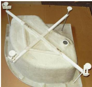
Г) Зафиксируйте шпильку в верхнем креплении поддона таким образом, чтобы шпилька имела неподвижную сцепку с креплением.
