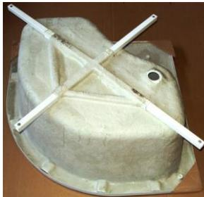
В) Установите шпильки таким образом, чтобы они вошли в верхние крепления поддона. С помощью гаек зафиксируйте подвижный каркас. Установите уголки крепления экрана. Установите ножки, не фиксируя их гайками, чтобы при выравнивании поддона можно было менять высоту и уровень.
