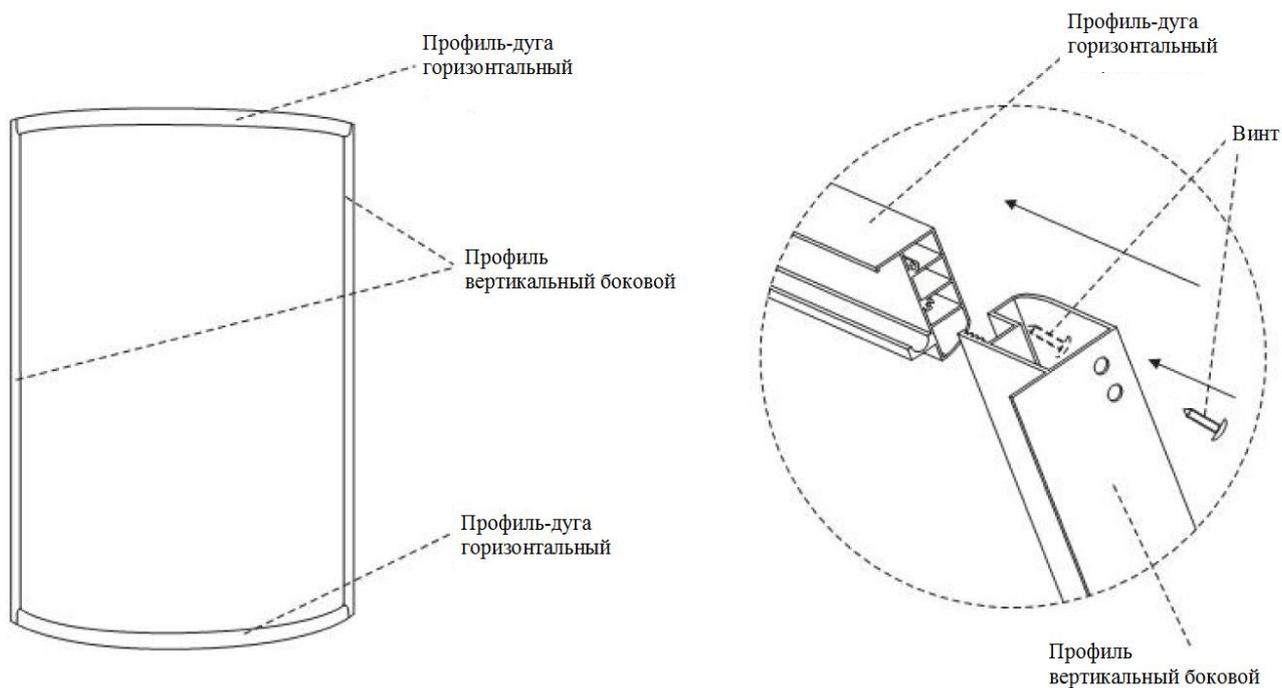
С помощью уровня установите вертикальные профили и зафиксируйте их на стене с помощью пластиковых дюбелей и саморезов (если необходимые отверстия отсутствуют их надо высверлить). Установите декоративные колпачки.
