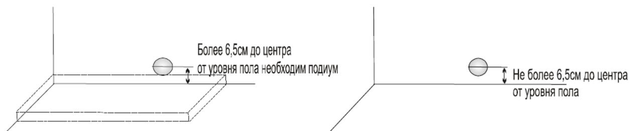
При невозможности обеспечить указанную на установочной схеме высоту сливной трубы, на месте установки изделия должен быть сооружен подиум. Высота подиума должна быть такой, чтобы расстояние от его поверхности до центра сливной трубы не превышало величину, указанную на установочной схеме.
