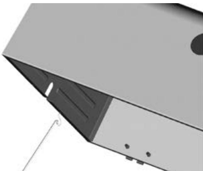
Затем проденьте другой конец дверного ограничителя в отверстие в боковой панели нижней секции гриля. Вместе с помощником присоедините нижний конец дверного ограничителя к нижней секции гриля с помощью шестигранного винта  $\frac{1}{4}$ -20x1 1/2", шайбы 1/4" и контргайки, как показано на рисунке. Винт вставляется снаружи. Проделайте то же самое, присоединяя второй дверной ограничитель.
