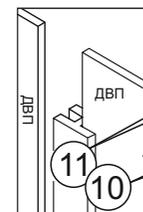
Схема крепления соединительного элемента
