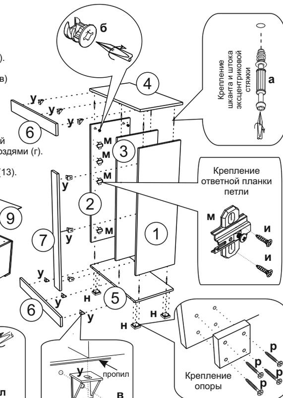
6. При установке фасадов (14,15) необходимо накладные петли (л) вставить в готовые отверстия и закрепить шурупами 4x16 (и).
