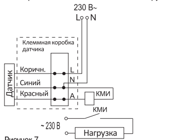
Рисунок 7. Схема подключения датчика с контактором КМИ
