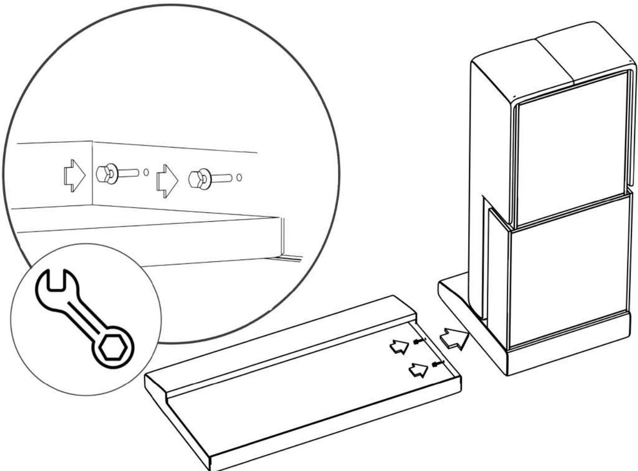
2. Слева от оттоманки, на полу, устанавливаем фальш спинку, крепим к оттоманке с помощью двух болтов М8 (ключ 13)
