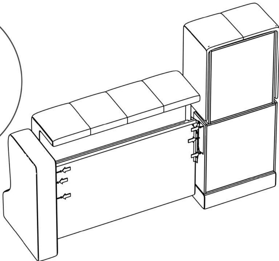
4. Установить посадочное место в положение, как на изображении. Приподнимая механизм посадочного места укрепить верхнюю часть с помощью болтов 6 шт. М8 (ключ 13) с обеих сторон. В целях удобства и безопасности рекомендуется производить данную процедуру вдвоем.
