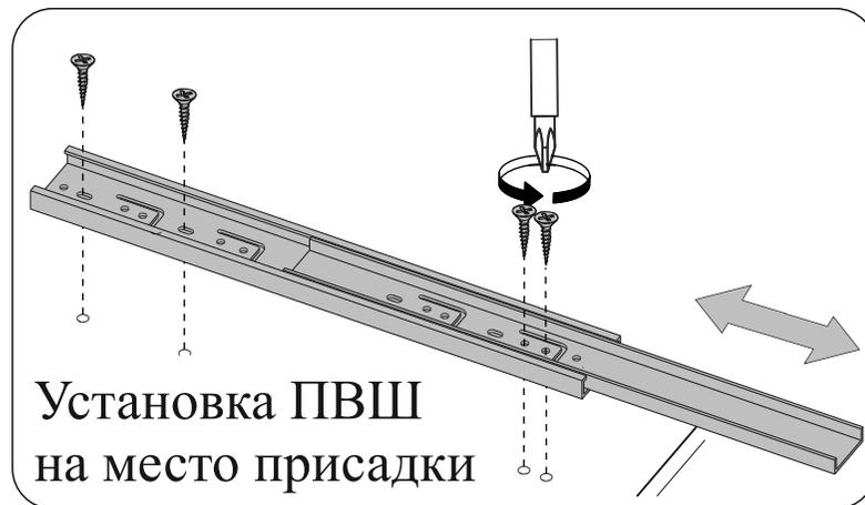
Порядок монтажа шариковых направляющих полного выдвижения
