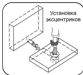
Эксцентрик вкручивается до большой шляпки
