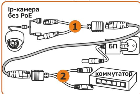
Подключите выходные разъемы сплиттера к кабелю камеры. Разъем RJ45 инжектора питания подключите в гнездо сетевого коммутатора, а разъем питания инжектора к разветвителю питания.
