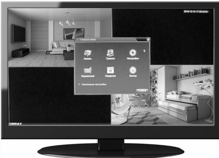
С подключенных к регистратору камер начнётся трансляция видео в режиме реального времени. Иконка кассеты в нижнем углу каждого канала сообщит о начале записи видео с конкретной камеры. Для управления настройками регистратора и просмотра видеoarхива необходимо изучить прилагаемое «Руководство пользователя видеорегистратора».
