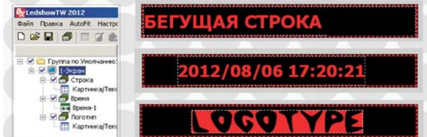
Для синхронизации времени компьютера с табло нужно нажать на кнопку в верхнем меню.
