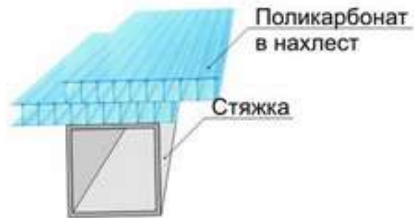
Рис. 6 Крепление поликарбоната к металлическому каркасу
