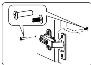
После сборки изделия и установки его по месту, рекомендуем стянуть его с соседними модулями межсекционными стяжками. Для этого необходимо предварительно просверлить отверстия  $\varnothing 5-6$  мм
