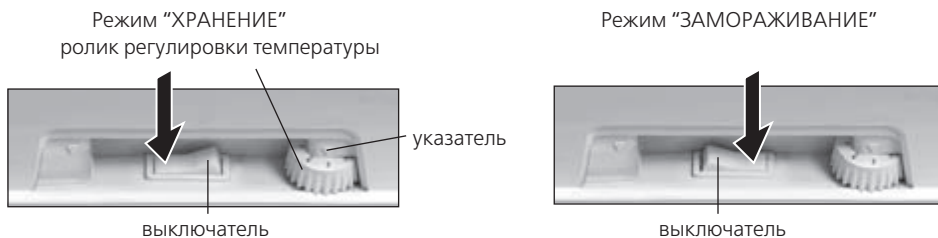
Рисунок 7 — Схема переключения режимов в морозильнике М-7184-XXX
