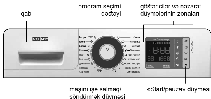
Şəkil 1 – İdarəetmə paneli
