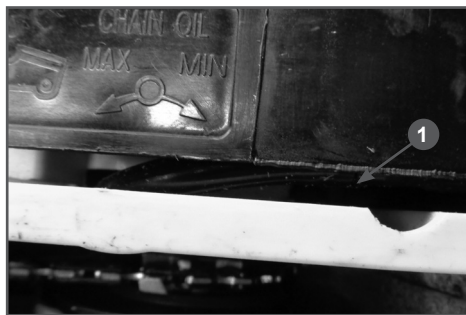
Рис. 8 Винт регулировки подачи масла
