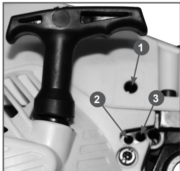
Рис. 21 Винты регулировки карбюратора 1 - винт «L», 2 – винт «H», 3 - винт «T»
