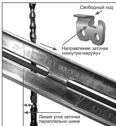
Рис. 22 Расположение линии угла заточки
