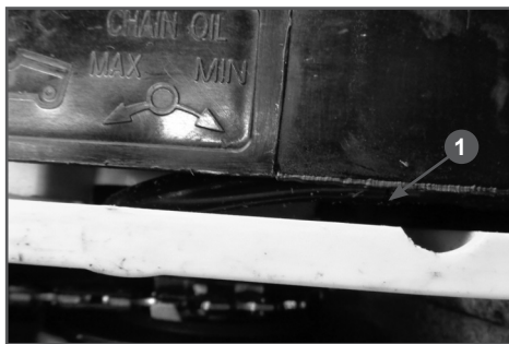
Рис. 8 Винт регулировки подачи масла
