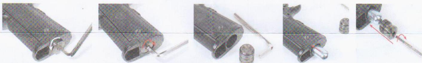
Открутите поджимную крышку баллона против часовой стрелки при помощи шестигранного ключа.
