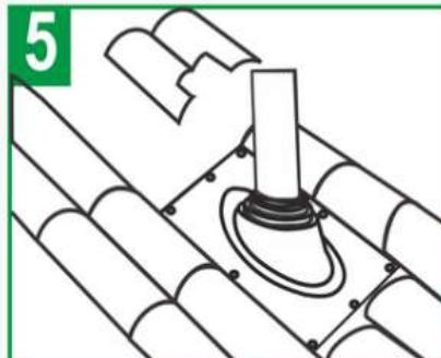
Вырежьте верхние элементы кровли по форме уплотнителя. Нижняя часть алюминиевого фланца должна остаться сверху кровли
