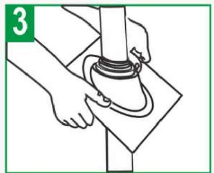
Снимите элементы кровли вокруг трубы, натяните уплотнитель на трубу
