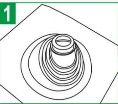
Вырежьте в мемbrane отверстие, соответствующее диаметру трубы
