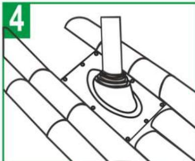
Установите и закрепите саморезами уплотнитель на кровлю
