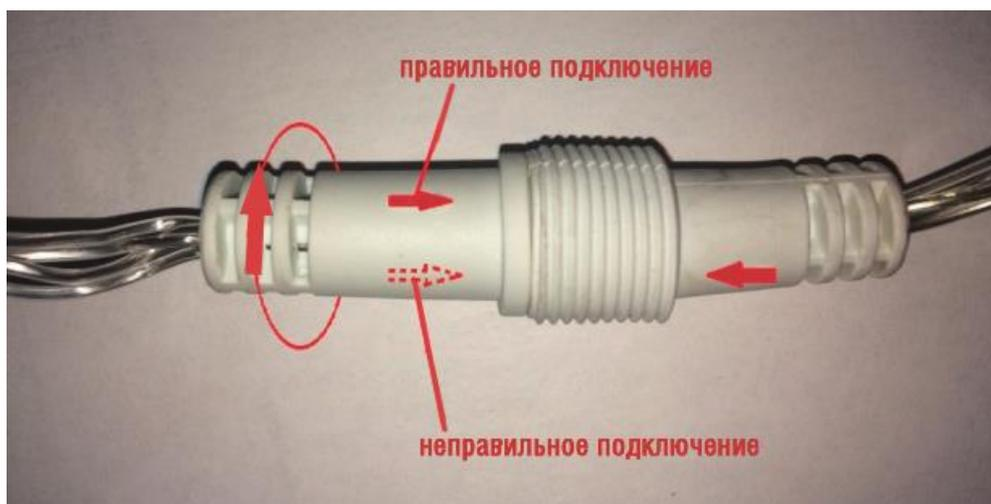
Для соединения гирлянд между собой необходимо произвести подключение обычным способом с совмещением направляющих и стрелок.
