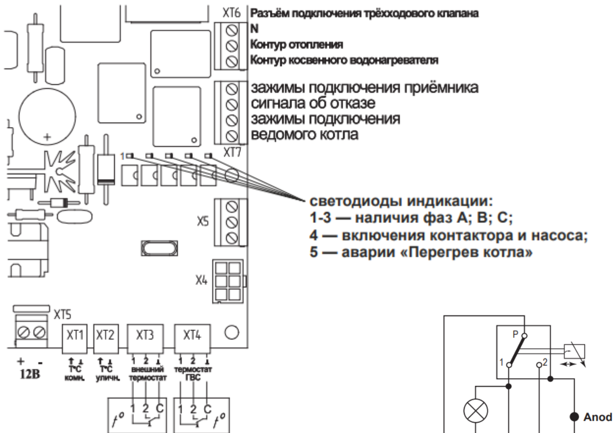
Рис. 1 Схема коммутационной платы котла STOUT.
