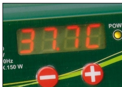
Экран, на котором отображается установленная внутренняя температура (рядом со значением температуры стоит "C")
