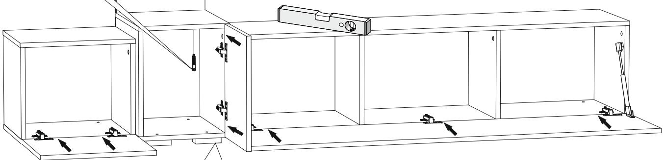
Регулировкой опор установить шкаф в горизонтальное положение
