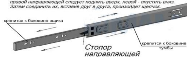
Рис.2 Схема установки шариковых направляющих
