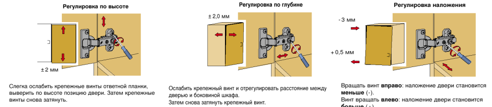
Рис.3 Схема установки петель
