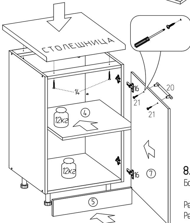
7. После сборки и установки на место каркаса шкафа прикрутите столешницу шурупами (14). Навесьте фасад (7) на левую или правую сторону. Установите цоколь (5). Досверлите отверстия под ручку и прикрутите ручки (20) с помощью винтов (21). Настоятельно рекомендуем Вам при досверливании отверстий под ручку подкладывать и плотно прижимать с лицевой стороны фасада кусок плитного материала или деревянный брусок.
