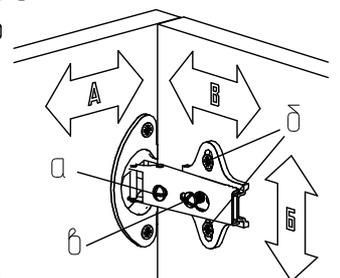
8. Схема регулировки дверей
