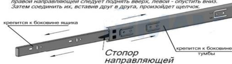
Рис.2 Схема установки шариковых направляющих
