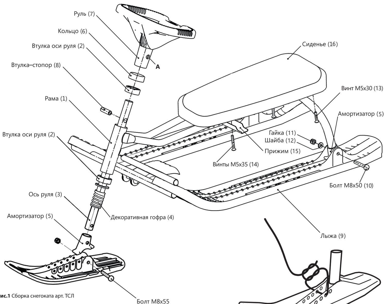
Рис.1 Сборка снегоката арт. ТСЛ
