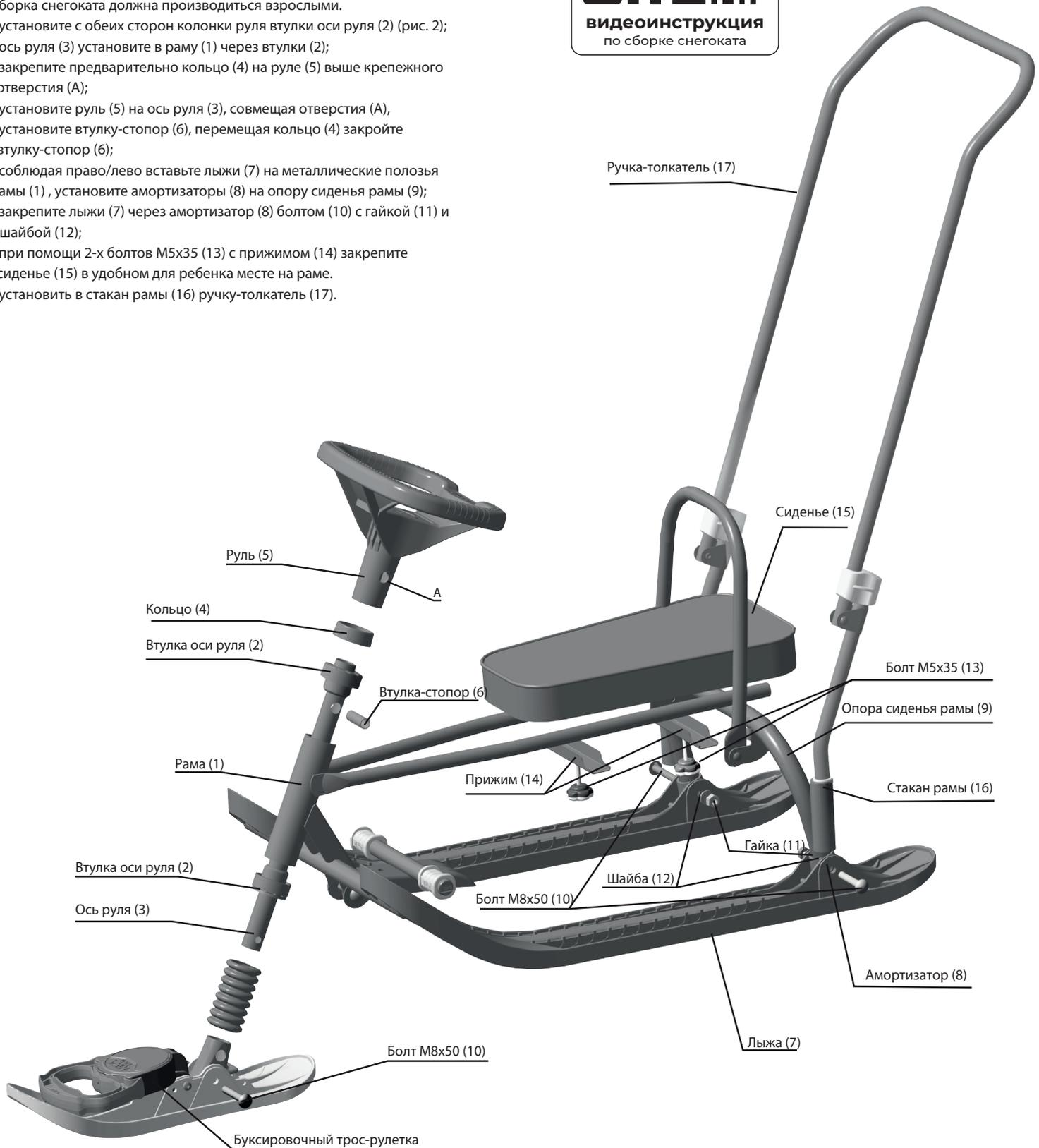
Рис. 2 Сборка снегоката TWINY2+ (арт. TW2+)
