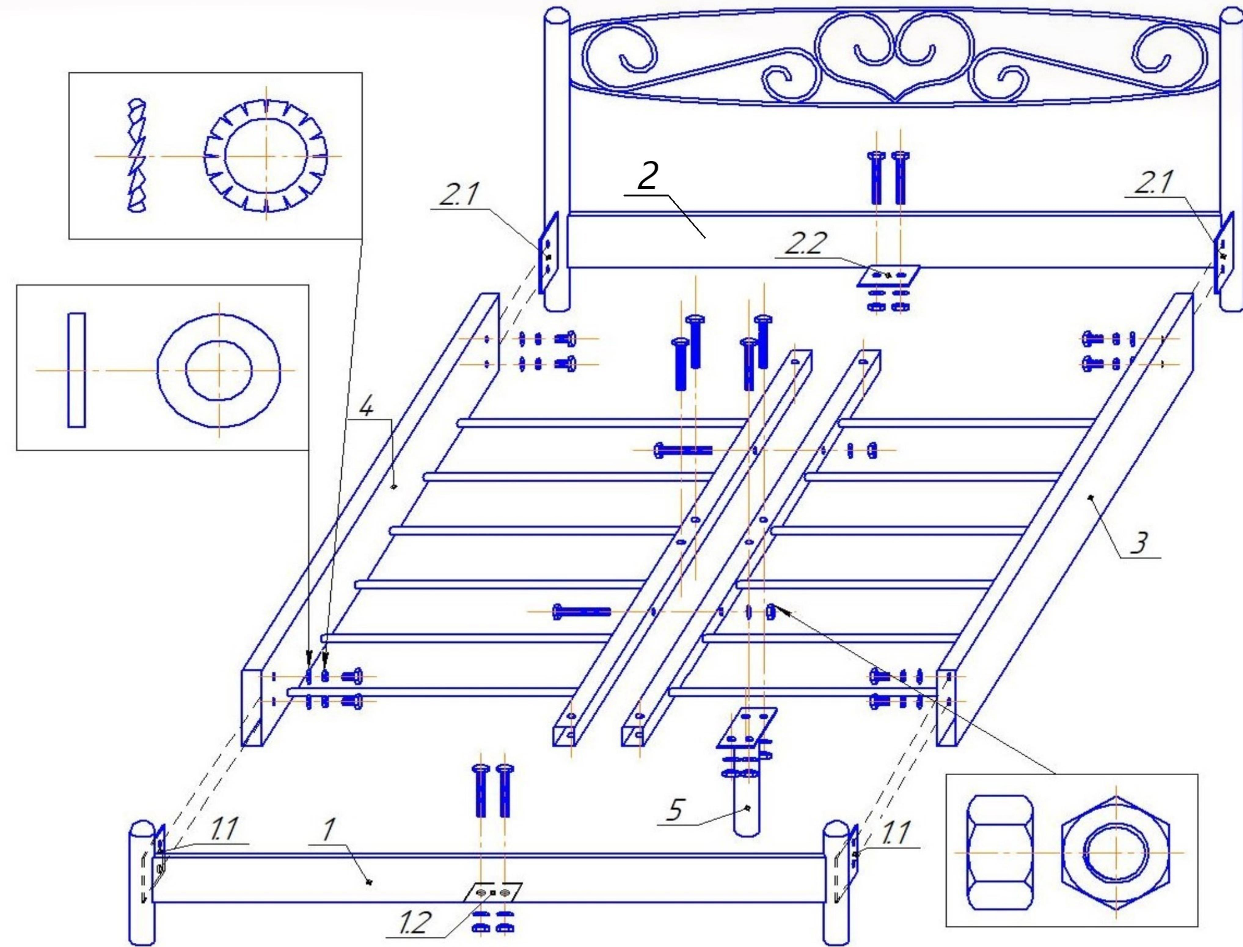
При установки кровати на неровный пол в конструкции предусмотрена система регулировки 5й ножки по высоте
