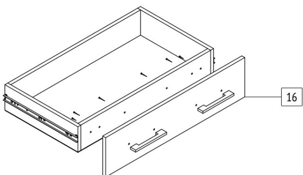
Закрепление накладок ящиков саморезами 3,5x30 осуществлять только после окончательной регулировки накладок.
