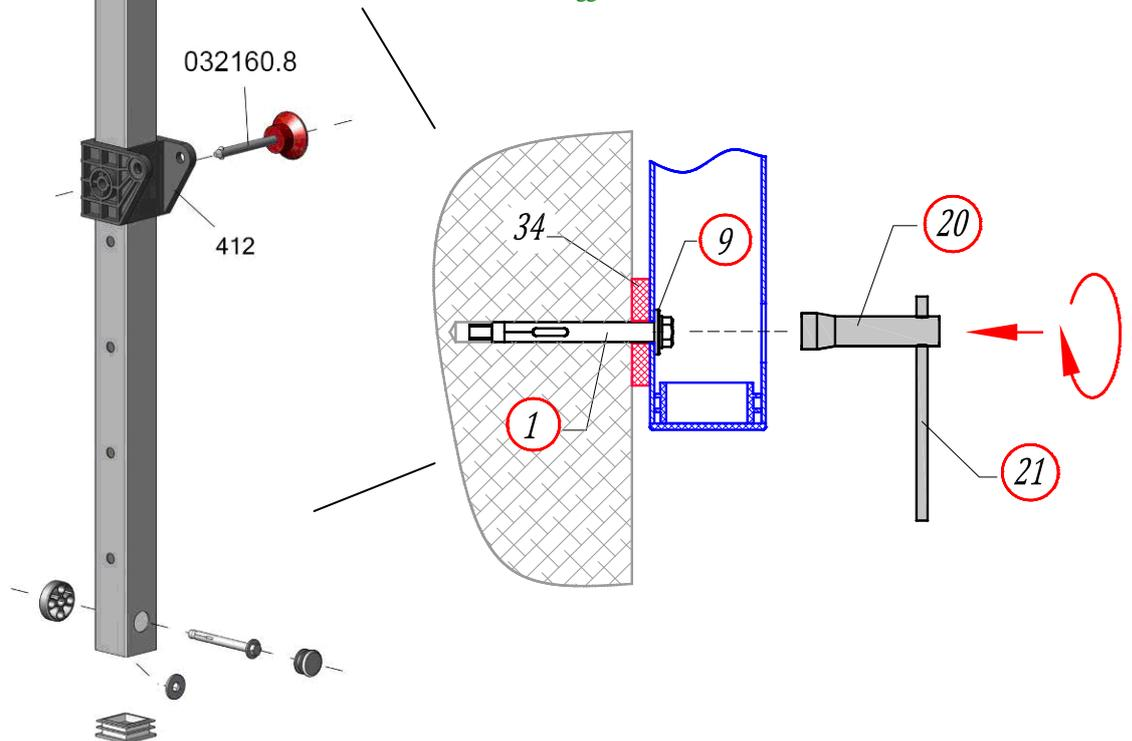
Строго придерживайтесь данных размеров, выдерживайте горизонталь. Отверстия в стене засверливайте аккуратно на нужную глубину, не допускайте разбития отверстий при сверлении и увода сверла в сторону от намеченной точки.
