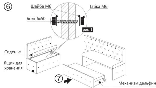
**Шаг 6** Соединить между собой два модуля при помощи 2х болтов 6x50 (Рис.1). Производить крепеж следует через ящик для хранения.
