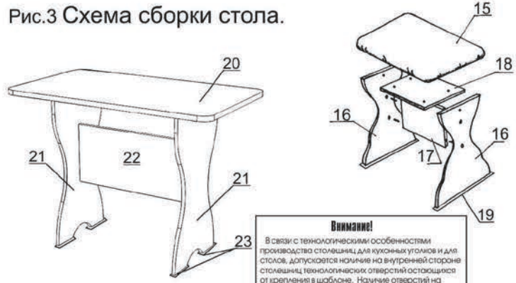
Рис.2 Схема сборки табурета
