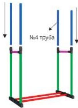
5. Возьмите 4 трубы №4 вставьте их, как показано на рисунке. Настройте нужную высоту и закрутите гайки.
