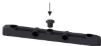
1. Возьмите защитный колпачок и вставьте в основание на обоих концах отверстия, соберите 2 комплекта.
