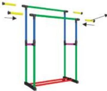
5. Возьмите 4 трубы №5, установите защитный колпачок, вставьте в тройник, как показано на рисунке.
