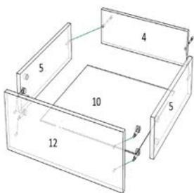
Еврошурупами скрепить детали 4 и 5, в пропил вставить ЛДВП. Ввернуть эксцентрики в деталь 12 и закрепить фасад к корпусу ящика замками. Привернуть направляющие к нижней части ящика колесом назад. Вкатить ящик в корпус пенала.
