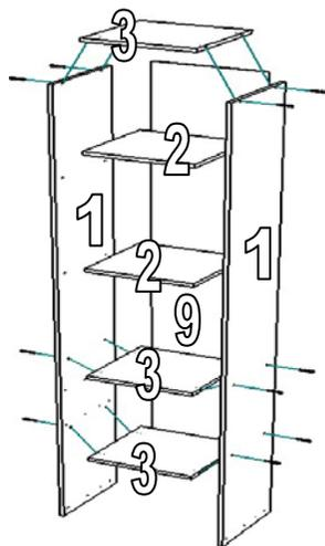
**Внимание!!!** Во избежание перекоса створок, после того как секция собрана в коробку, необходимо измерить диагонали, они должны быть одинаковыми. Только после этого можно прибивать заднюю стенку, используйте это примечание при сборке каждой секции или её части.
