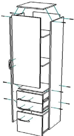
С помощью петель и шурупов установить фасад на корпус пенала и отрегулировать с помощью регулировочных винтов.
