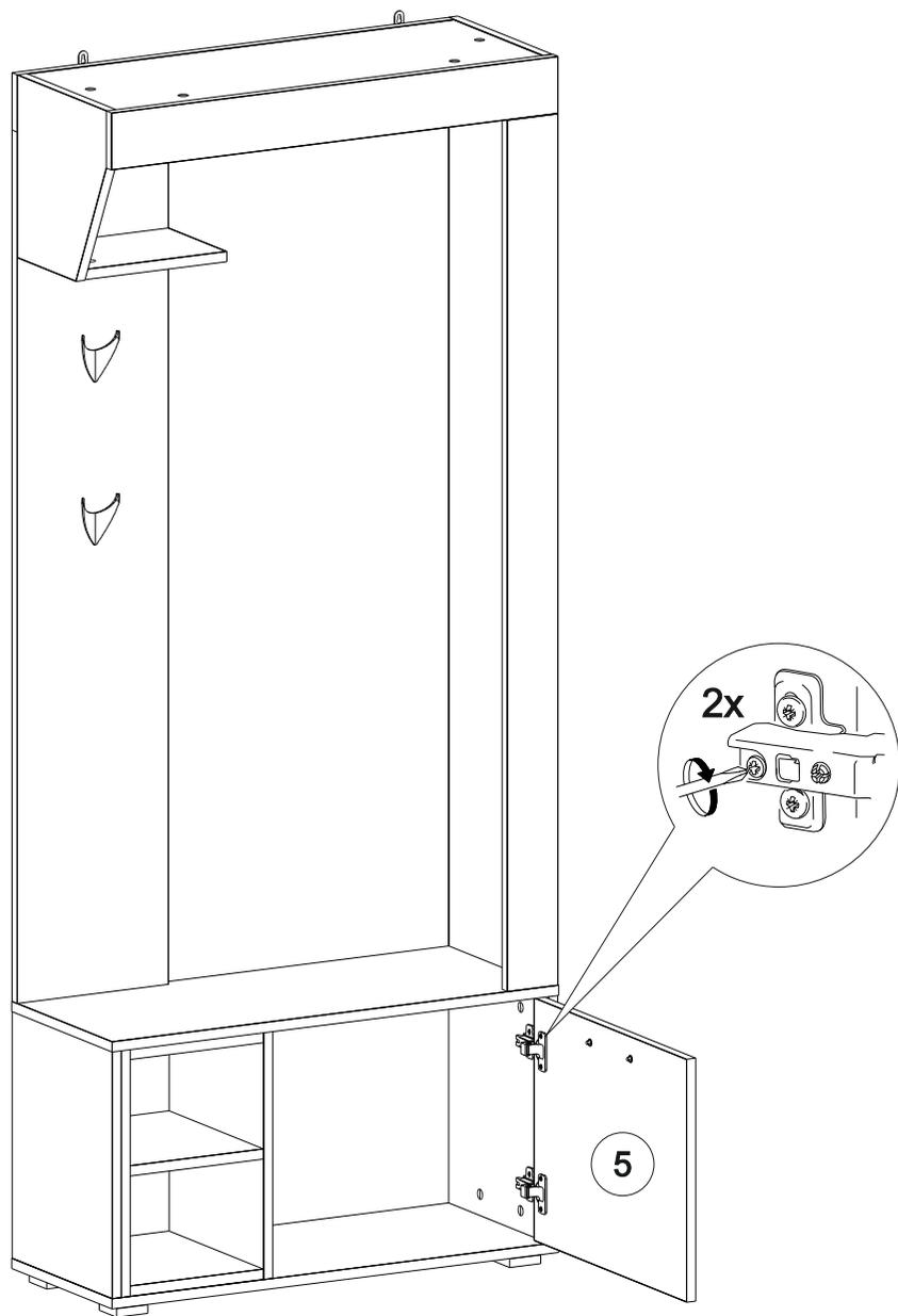
**РЕГУЛИРОВКА ДВЕРНЫХ ПЕТЕЛЬ:**
