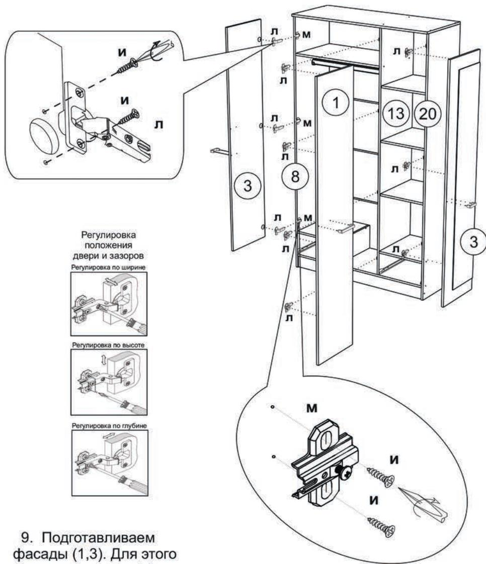
9. Подготавливаем фасады (1,3). Для этого накладные петли (л) необходимо вставить в готовые отверстия и закрепить шурупами 4x16 (и), ответную планку петли (м) крепим к боковинам (8,13,20), также шурупами 4x16 (и).
