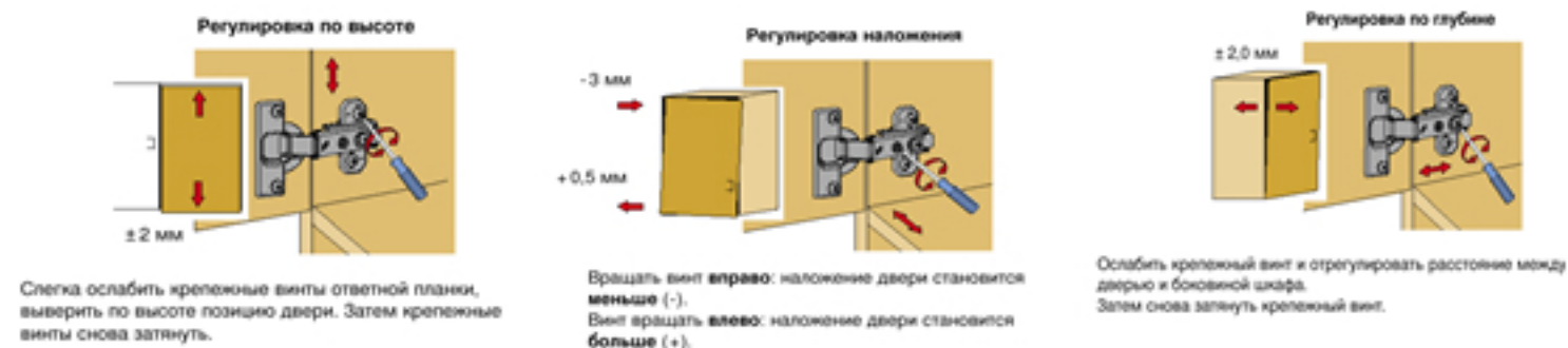
Рис.3 Схема установки петель
