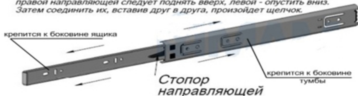
Рис.4 Схема установки направляющих
