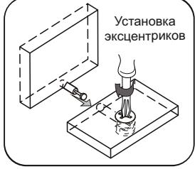
Эксцентрик вкручивается до большой шляпки
