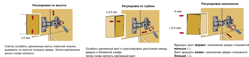
Рис.2 Схема установки петель
