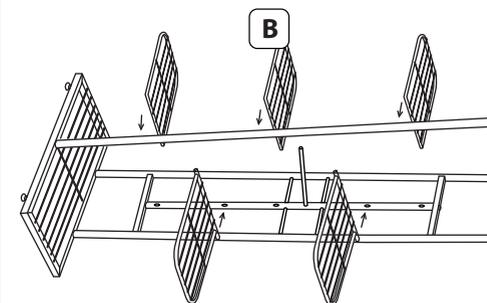
6. Закрепите второй конец соединительной трубки **H** с помощью винта **I**. Затяните оба винта соединительной трубки, иначе установленные полки смогут легко выпасть.
