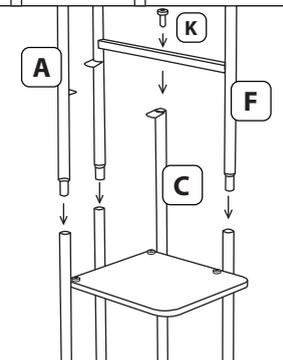
3. К нижней боковой раме **F** прикрутите трубку **C** с помощью длинного винта **K**.
