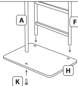
6. Установите трубку **A** и верхнюю раму **F**, как показано на рисунке. Прикрепите трубку **C** с помощью длинного винта **K** к верхней раме **F**.
