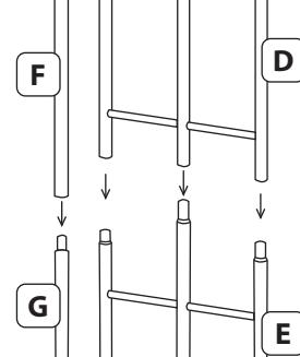
4. Установите соединяющую трубку **H**, как показано на рисунке, и закрепите с одной стороны винтом **I**. Со второй стороны пока не прикручивайте, иначе вы не сможете установить полки.
