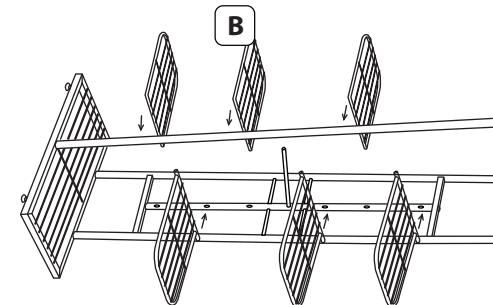
6. Закрепите второй конец соединительной трубки **H** с помощью винта **I**. Затяните оба винта соединительной трубки, иначе установленные полки смогут легко выпасть.
