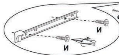
2. Предварительно к боковинам (1,2) фиксируем роликовые направляющие (о) шурупами 4x16 (и) и к торцам крепим подпятники (ю) гвоздями (г).
