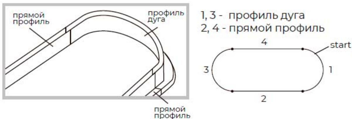
4. Вставьте фиксатор в места стыков соседних профилей внутрь паза.
