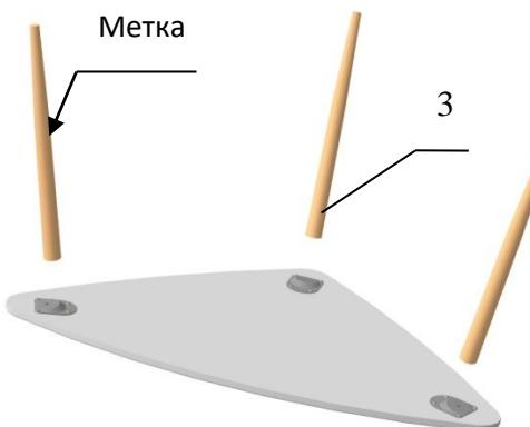
**3.** Установить полку поз. 2 и закрутить шурупами поз. В, совместив метки на ножках с отверстиями в полке.
