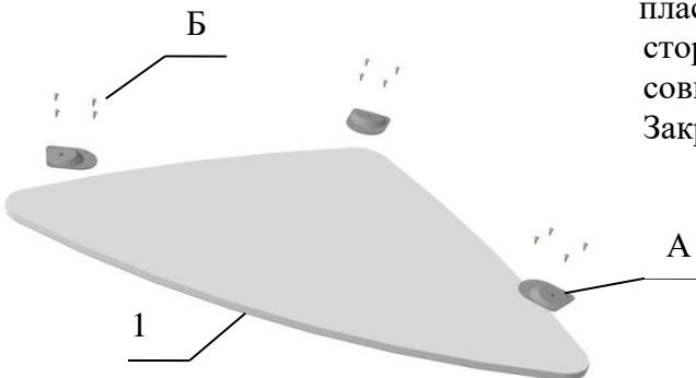
**2.** Вкрутить опоры поз.3., направив метки внутрь стола, для прикручивания полки.
