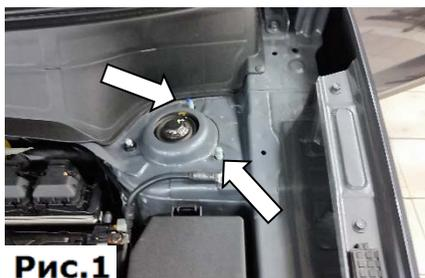
1. Торцевой головкой №14 открутить болты крепления стойки, показанные на рисунке (Рис.1).
