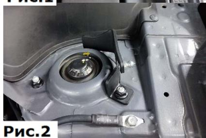
2. Установить кронштейн, сдвинув к центру стойки. Затянуть штатные болты торцевой головкой №14 с усилием предписанным заводом-изготовителем (Рис.2).
