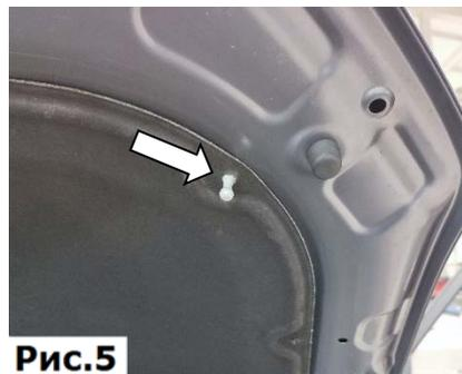
5. Закрутить в закладную шарнир с шайбой 6, затянуть торцевой головкой №10 с усилием 9Нм. Надеть обшивку на проточку шарнира и вставить оставшийся пистон (Рис.5).
