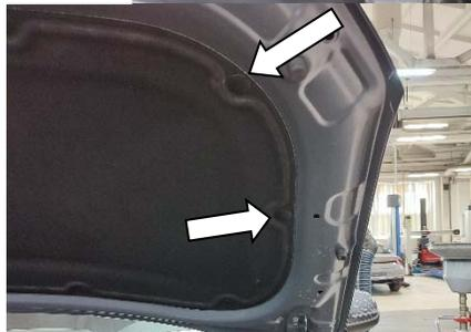
3. Демонтировать пистоны крепления обшивки капота, показанные на рисунке (Рис.3).
