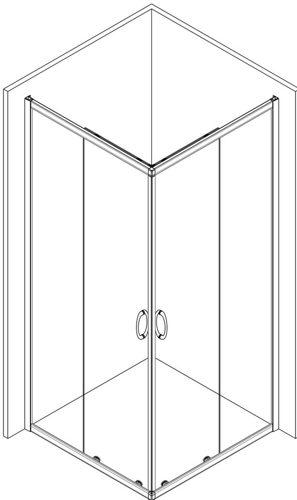
Чтобы предотвратить утечки, силиконовый герметик должен быть применен за пределами душа, а не на внутренней части. Прочитайте все инструкции внимательно прежде чем начать установку. Сохраните данную инструкцию для дальнейшего использования.
